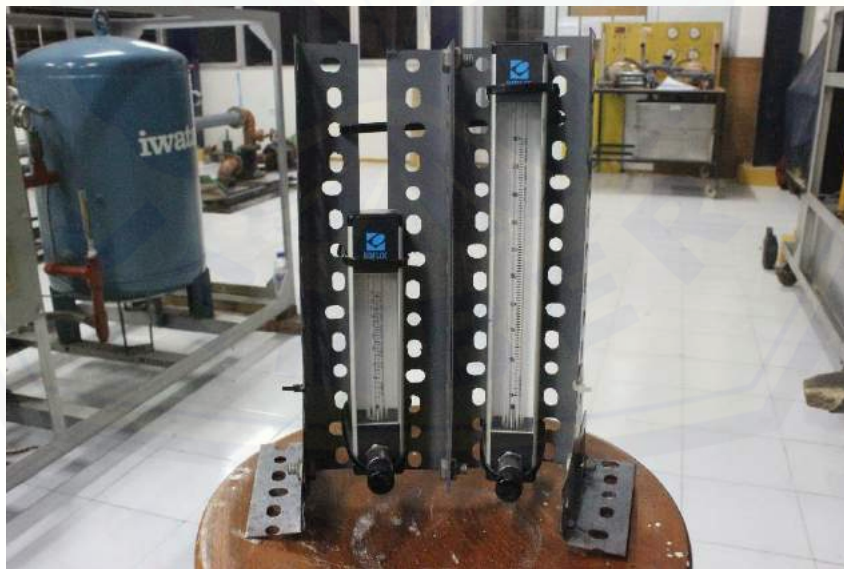
Gambar 3.5 Flowmeter (Sumber: Dokumentasi Pribadi)
