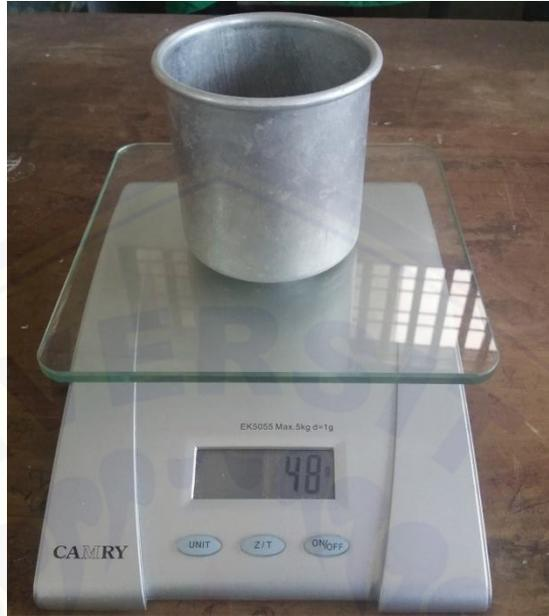
Gambar 1. Pengukuran massa kalorimeter kosong (bejana aluminium)
