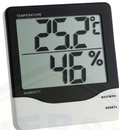
Gambar 3.4 *Thermohygrometer*
