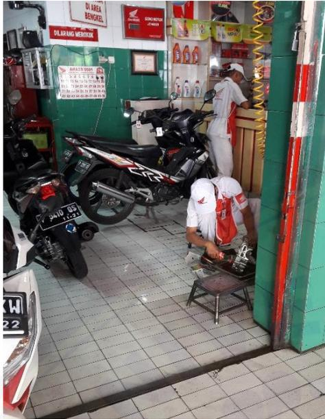
Gambar 9. Proses pembersihan mesin sepeda motor dengan bensin
