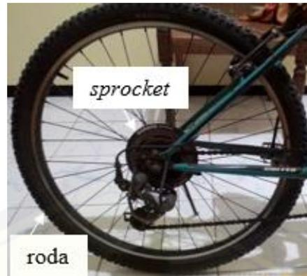
Gambar 2.8. *Sprocket* dan roda belakang sepeda (Sumber: dokumen pribadi)
