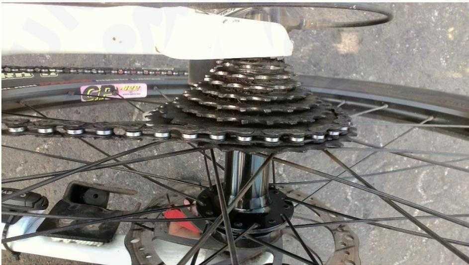
Gambar 3.3 *Sprocket* pada *Polygon Broadway 3.0*
