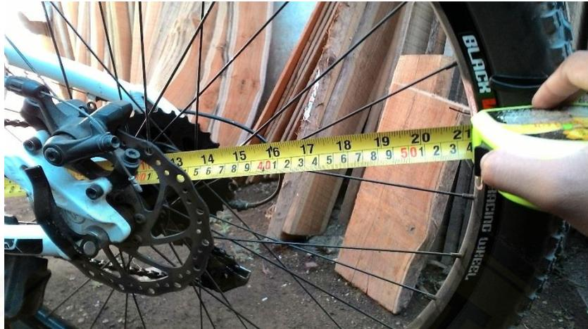
Gambar D.7 Pengukuran diameter roda
