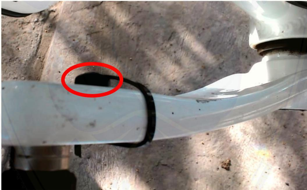
Gambar D.6 Letak magnet *cadence*
