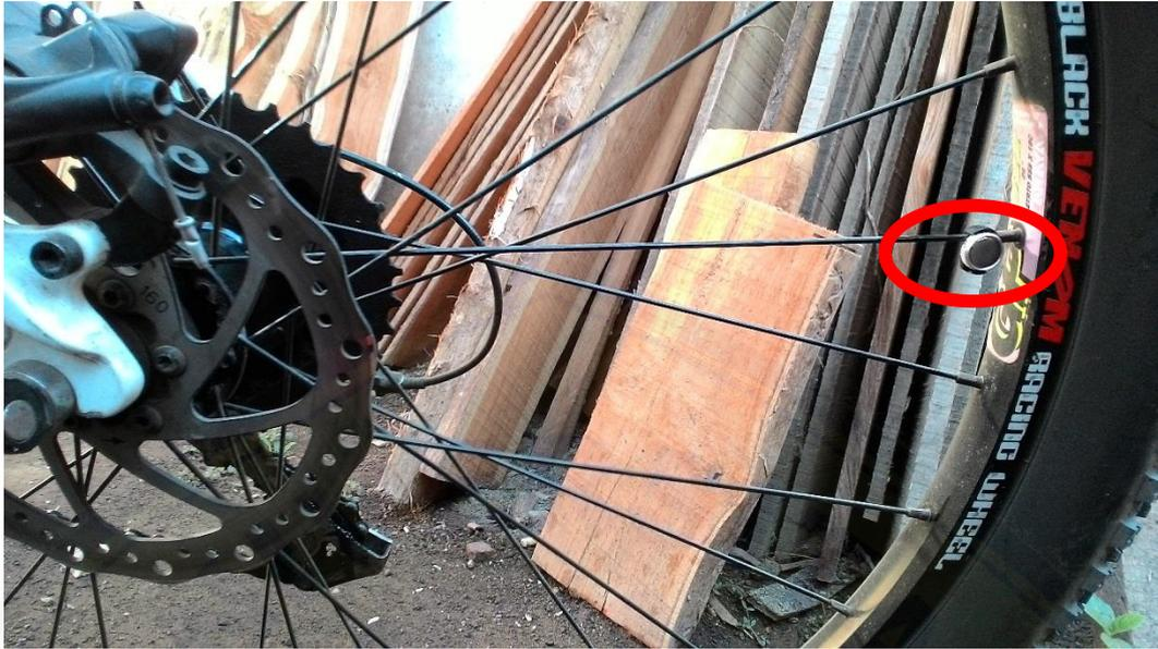
Gambar D.5 Letak magnet kecepatan sepeda
