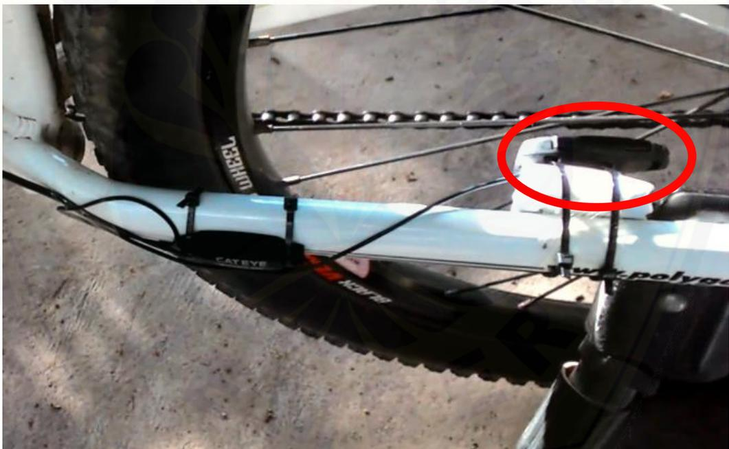
Gambar D.4 Letak sensor kecepatan sepeda
