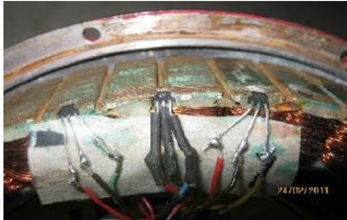
Gambar 2.6 Posisi Hall Sensor Pada Motor BLDC ( http://electricisart.blogspot.com )
