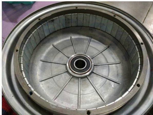
Gambar 2.2 Rotor (magnet permanen)
