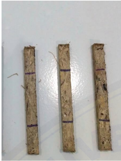
Gambar sebelum uji bending pada temperatur sintesis 100°C
