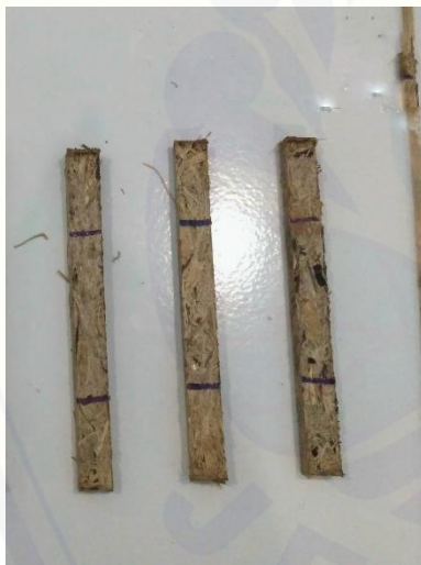
Gambar sebelum uji bending pada temperatur sintesis 110°C
