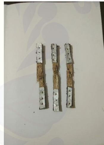
Gambar sesudah uji tarik pada temperatur sintesis 100°C
