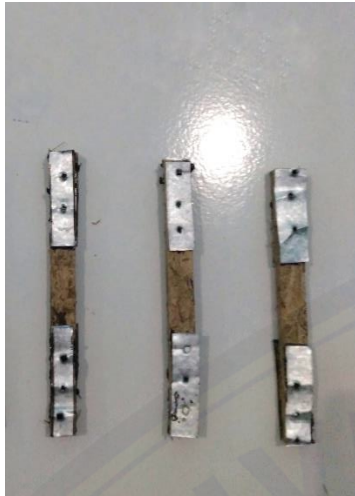
Gambar sebelum uji tarik pada temperatur sintesis 110°C
