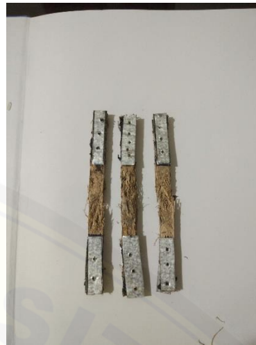
Gambar sesudah uji tarik pada temperatur sintesis 110°C
