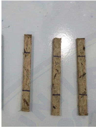
Gambar sebelum uji bending pada temperatur sintesis 80°C
