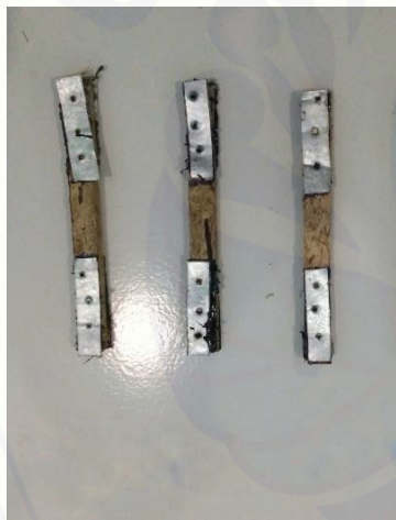
Gambar sebelum uji tarik pada temperatur sintesis 100°C
