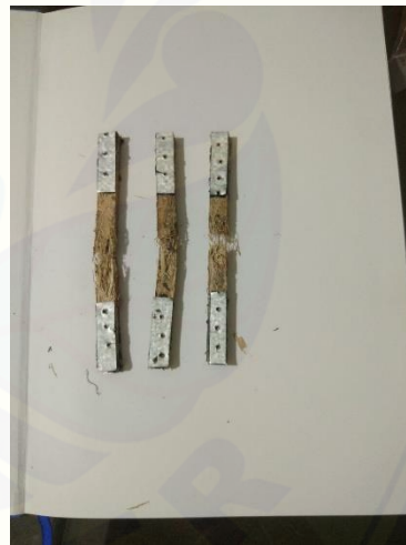
Gambar sesudah uji tarik pada temperatur sintesis 120°C
