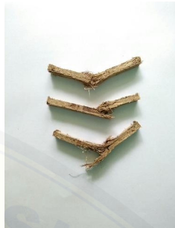
Gambar sesudah uji bending pada temperatur sintesis 120°C
