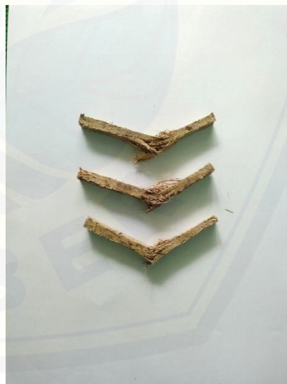
Gambar sesudah uji bending pada temperatur sintesis 90°C
