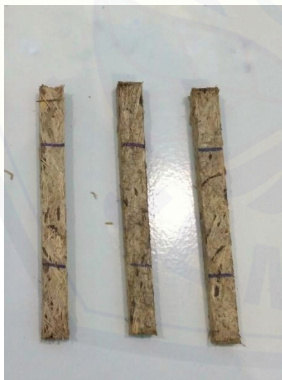
Gambar sebelum uji bending pada temperatur sintesis 90°C
