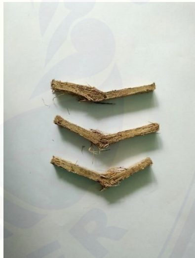
Gambar sesudah uji bending pada temperatur sintesis 110°C
