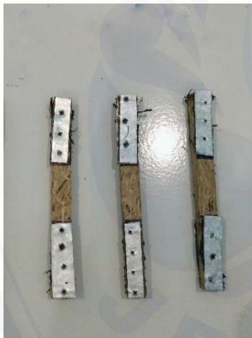
Gambar sebelum uji tarik pada temperatur sintesis 120°C
