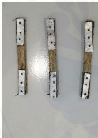
Gambar sebelum uji tarik pada temperatur sintesis 80°C
