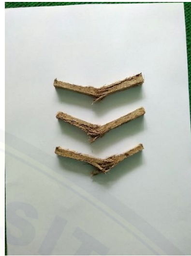
Gambar sesudah uji bending pada temperatur sintesis 100°C
