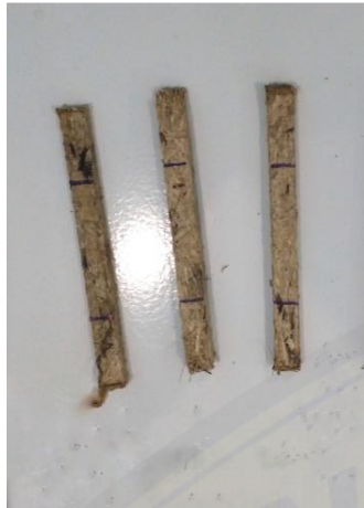
Gambar sebelum uji bending pada temperatur sintesis 120°C
