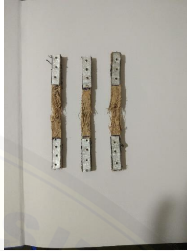
Gambar sesudah uji tarik pada temperatur sintesis 90°C
