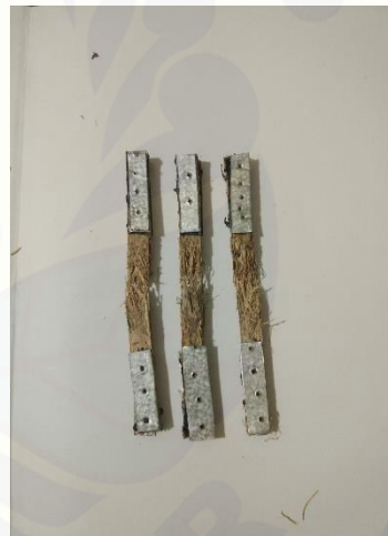
Gambar sesudah uji tarik pada temperatur sintesis 80°C
