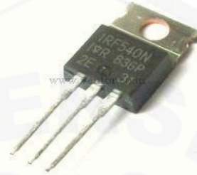
Gambar 2.6 MOSFET Tipe IRF540
