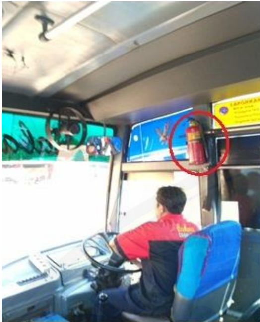
Gambar 5. Kondisi APAR pada salah satu kendaraan
