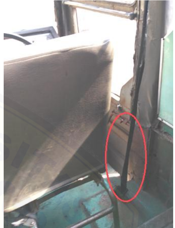
Gambar 2. Sabuk Pengaman Yang Tidak Sesuai Standar
