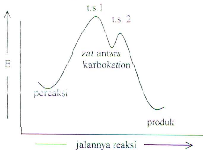
Gambar 5. Diagram energi untuk reaksi S_N1
