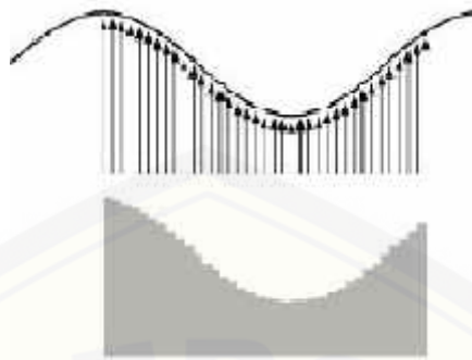
Gambar 2.5 ADC Dengan Kecepatan Sampling Tinggi
