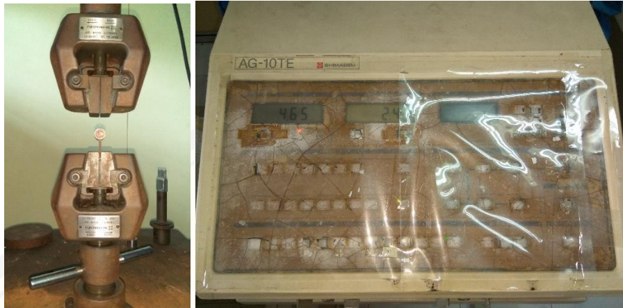
Pelepasan Braket dengan Menggunakan Universal Testing Machine
