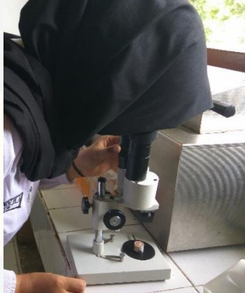
Pengamatan Sisa Adhesive dengan Mikroskop Stereo
