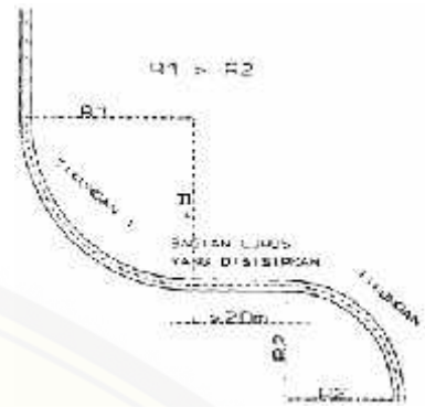
Gambar 2.4 Tikungan gabungan balik arah dengan sisipan bagian lurus minimum 20 m
