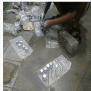
Mengeluarkan Spesimen Dari Cetakan
