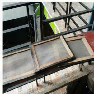
Saringan (600  $\mu\text{m}$ , 425  $\mu\text{m}$  Dan 300 $\mu\text{m}$ )
