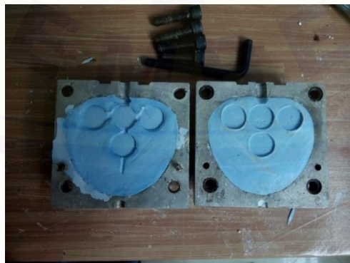
Kuvet yang sudah direbus air panas menghasilkan mould space
