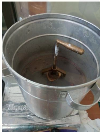
Perebusan kuvet untuk membersihkan dari model malam
