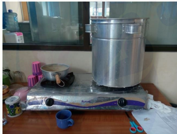
Perebusan kuvet untuk membersihkan dari model malam
