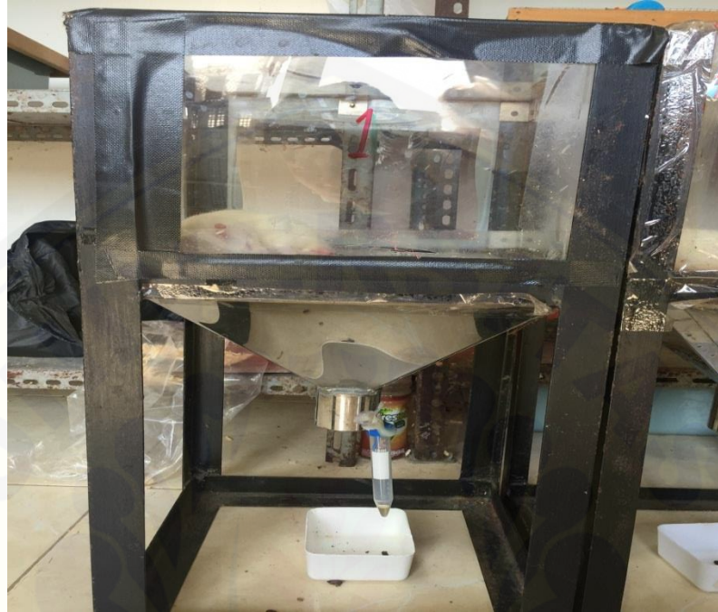
Gambar E.4.1 Tikus dikandangkan di dalam metabolic cage selama 8 jam untuk ditampung urinnnya.
