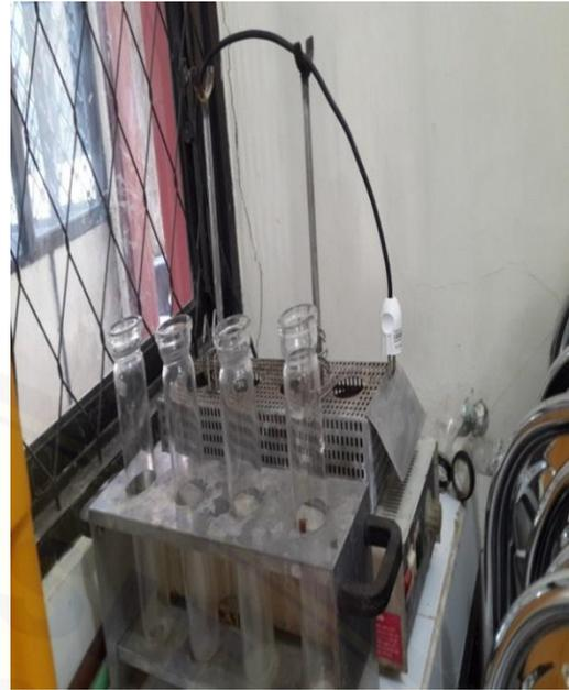
Gambar 6. Alat Destruksi Uji Protein
