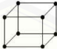
Gambar 2.2 Struktur kristal simple cubic (Sumber: Kittel, 1996)
