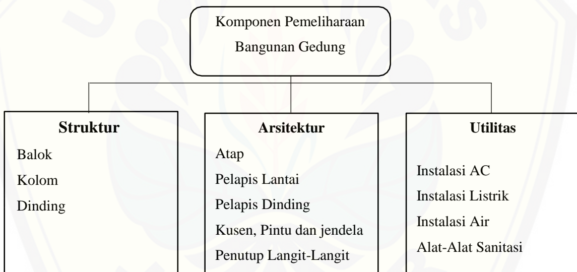
Gambar 3.3 Komponen Pemeliharaan Bangunan Gedung
