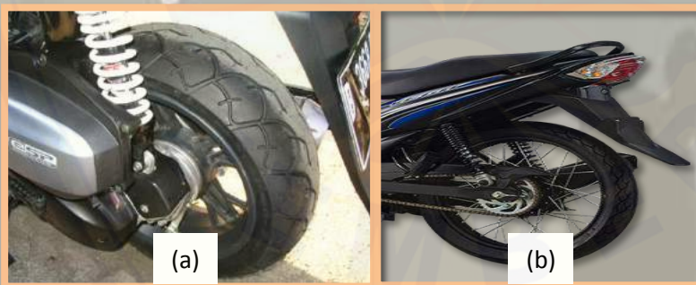
Gambar 3.6a Shockbreaker pada matic, 3.6b Shockbreaker pada motor bebek
