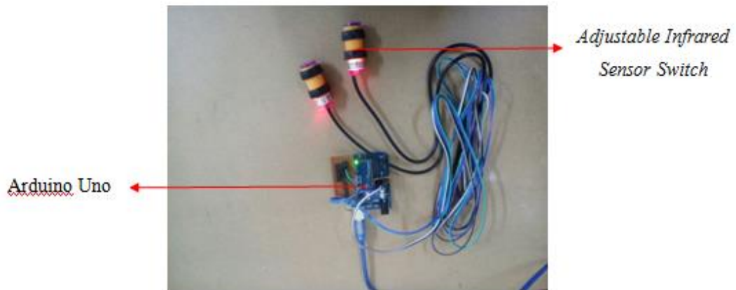
Gambar 3.4 Rangkaian Adjustable Infrared Sensor Switch dengan Arduino
