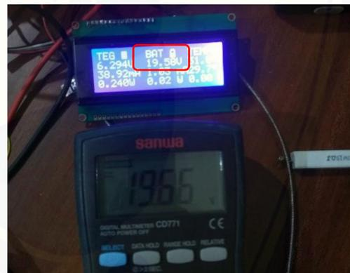
Kalibrasi sensor tegangan
