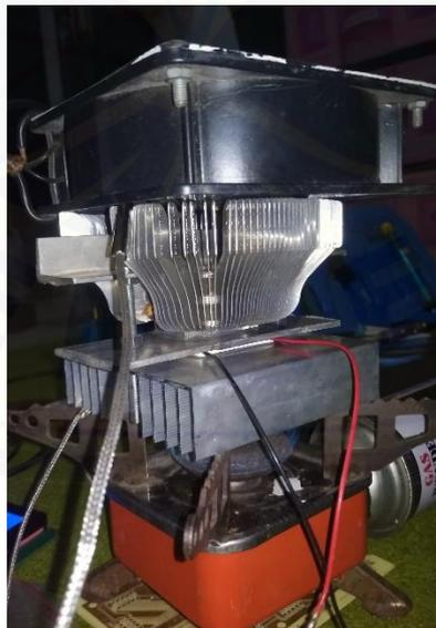
Gambar 3.5 Percobaan pengambilan data dengan 1 elemen generator
