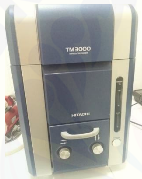
Penentuan ukuran partikel dan morfologi microspheres menggunakan SEM
