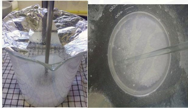
Proses pengadukan dengan four blades propeller sehingga terbentuk droplet
