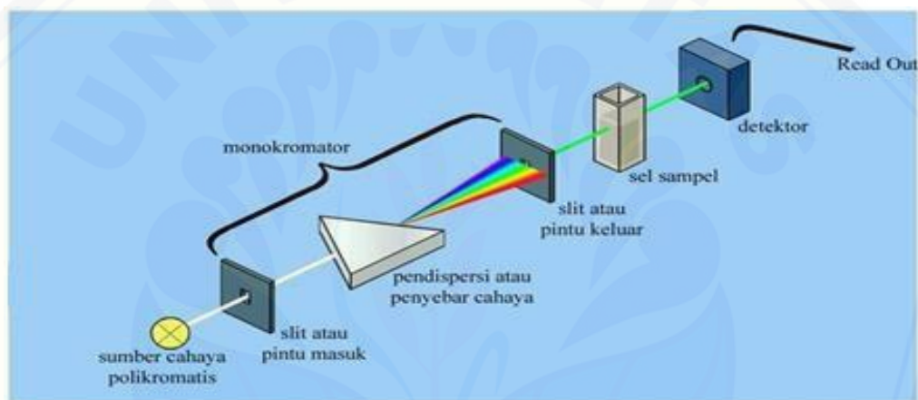
Gambar 2.4 Cara kerja spektrofotometer (Sumber: Anton, 2013)
