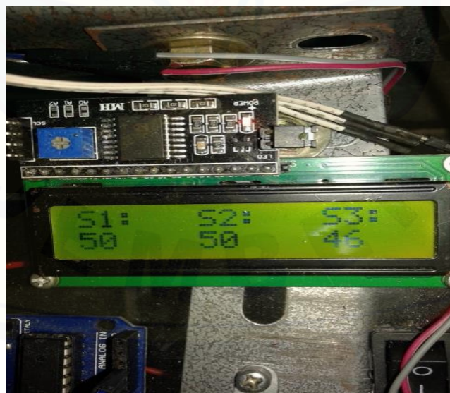
Tampilan ADC sensor 1, 2, dan 3 pada saat mendeteksi lapisan kayu
