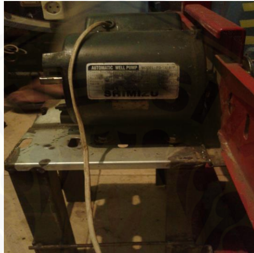
Gambar 2.3 Motor penggerak blade pada wind tunnel
