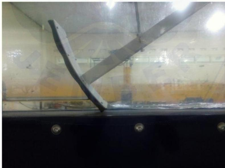
Gambar A.2 Profil Aliran pada saluran pada Bukaannya Pintu Radial 10 mm
