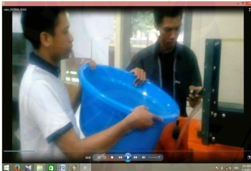
Gambar A.10 Pengukuran Debit Menggunakan Baskom/ Gelas Ukur
