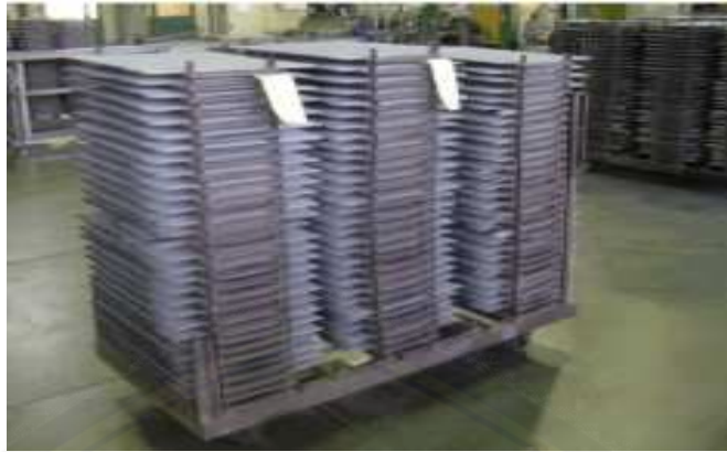
Gambar 2.10 Elektroda yang siap dipanaskan (Rad dan Ashrafizadeh, 2012)
