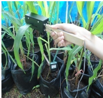
Gambar 4.6 Cara Mengukur Warna Daun jagung dengan alat Instrumen Ukur Kadar Kebutuhan Pupuk Urea Pada Tanaman Jagung Menggunakan Metode Fuzzy Logic
