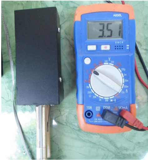
Gambar 4.7 Tegangan Photodioda Saat Tanpa Halangan
