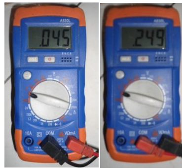
Gambar 4.10 Tegangan Output Sensor pH Sebelum dan Sesudah Dikuatkan
