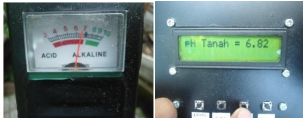
Gambar 4.11 Kalibrasi Sensor pH Tanah
