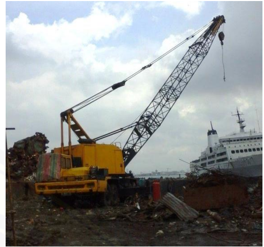
Gambar 14. Crane untuk mengangkat plat bangkai Kapal
