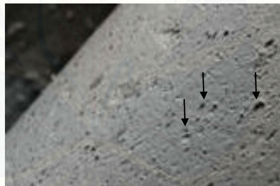
Gambar 3.2 Permukaan kawat NiTi non coated , tanda panah menunjukkan permukaan berpori dan tidak teratur
