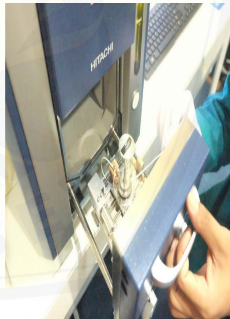
D. Penempatan Kawat pada Alat SEM.
