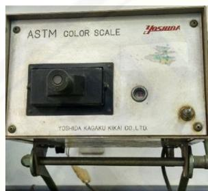
Mengetahui tingkatan warna kejernihan sampel yang ditunjukkan dalam skala uji dari 0,5-8,0
