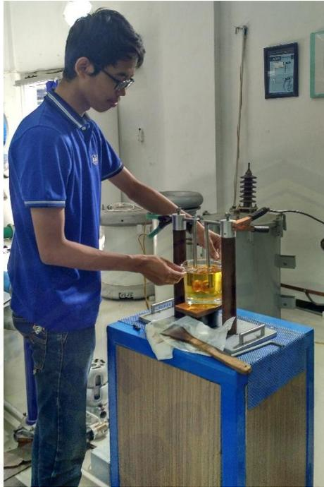
Gambar 4 Proses Pengujian Tegangan Tembus
