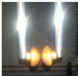
Berdiameter 50 mm bentuk dari elektrodanya setengah bola sebagai media pengujian tegangan tembus
