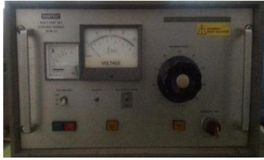
Digunakan untuk menaikkan tegangan dimulai dari 0 V sampai sekitar  $2,0 \text{ kV s}^{-1} \pm 0,2 \text{ kV s}^{-1}$  sampai timbul tegangan tembus
