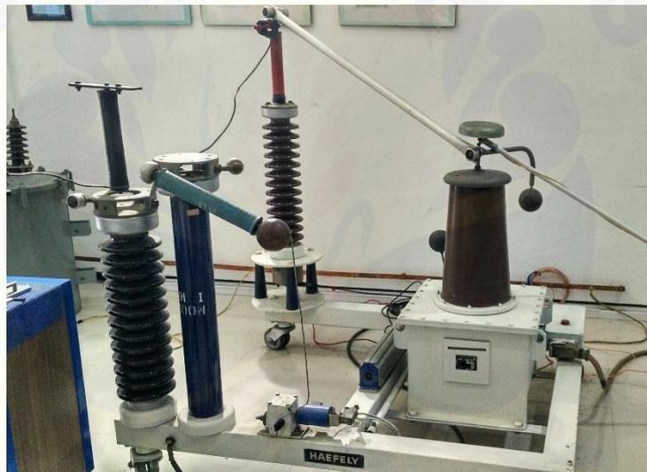
Gambar 2 Peralatan Pengujian Tegangan Tembus
