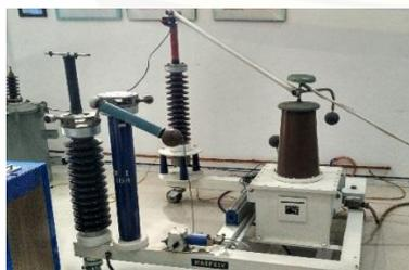
Peralatan pengujian tegangan tembus modul pembangkit tegangan AC (bolak-balik)
