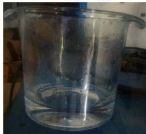
Digunakan untuk wadah minyak/sampel uji dalam pengujian tegangan tembus
