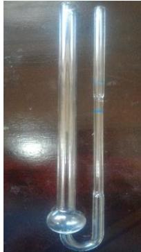
Untuk mengukur laju alir minyak dalam satuan sekon dari titik atas ke titik bawah yang tingginya 30 mm.
