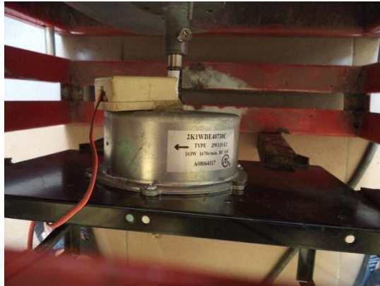
Gambar 2.1 Motor penggerak blade pada wind tunnel ( www.tokopedia.com )
