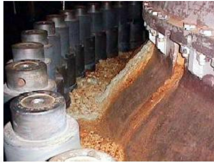
Gambar 2.1 Korosi baja pada reaktor Davis-Besse (Sumber: Crpytome , 2006)
