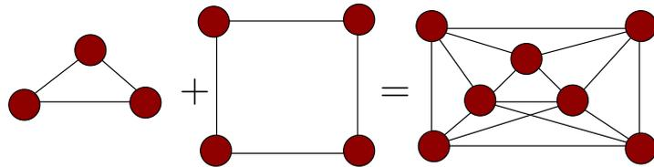
Gambar 2.11 Contoh Operasi *Joint* ( $C_3 + C_4$ )
