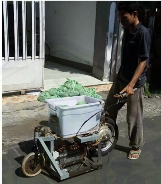
Gambar B.1 Pengambilan data Waktu Tempuh, Tegangan Aki dan Arus Aki
