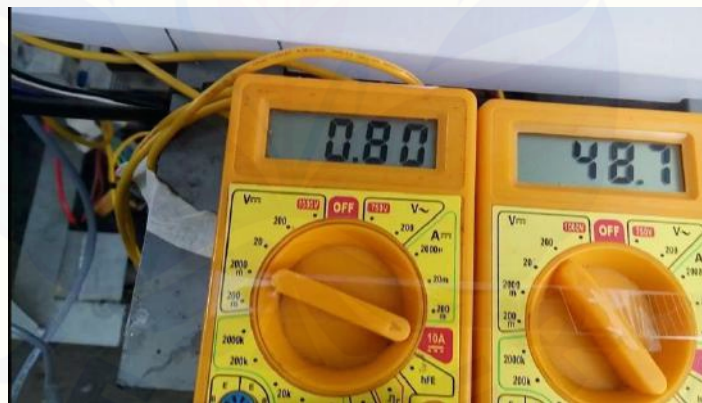
Gambar B.2 Pengukuran Tegangan dan Arus Aki
