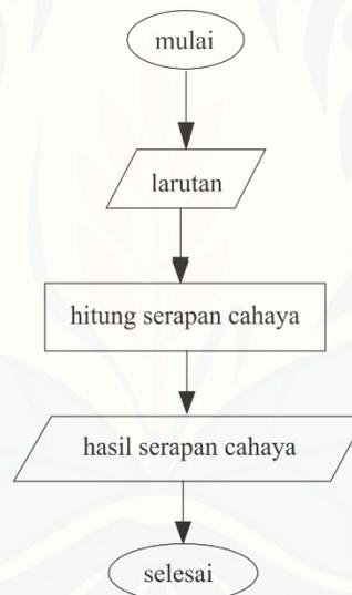
Gambar 3.2 Diagram alir pengumpulan data nilai serapan cahaya larutan glukosa dengan spektrofotometer
