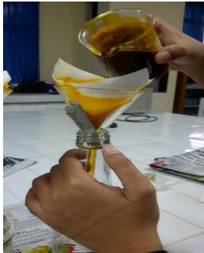
Penyaringan maserat dengan corong Buchner
