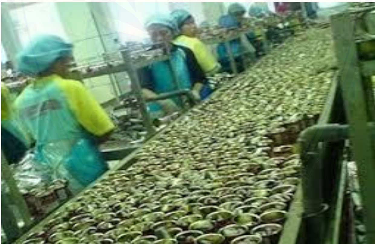
Gambar 2.1 Gambar Memasukan ikan kedalam Kaleng
