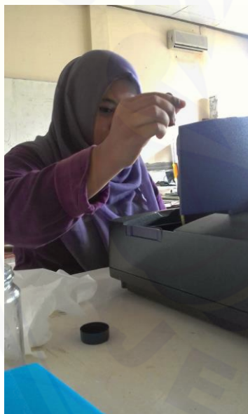
Lampiran 16e. Kegiatan mengukur absorbansi dengan spektrofotometer
