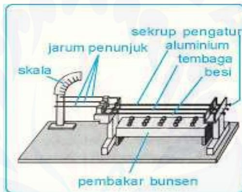
Gambar 1. Gambar Percobaan Muai panjang
