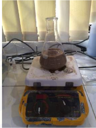
Gambar 3.3 Pencampuran abu ampas tebu dengan HCL menggunakan alat pengaduk magnet (Sumber : Koleksi Pribadi, 2016)
