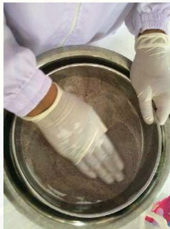
Gambar 3. 2 Mengayak abu ampas tebu menggunakan ayakan 200 mesh (Sumber : Koleksi Pribadi, 2016)
