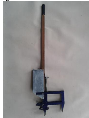
Gambar 2 Tugal Benih Kedelai Hasil Perancangan (Skala 1:15)
