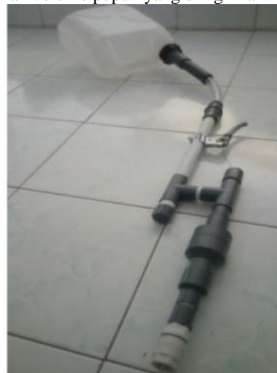
Gambar 4.1 Aplikator Pupuk Cair Setelah Dilakukan Modifikasi
