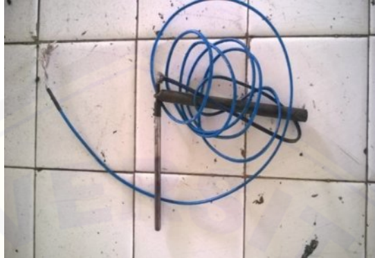
Gambar 3.2 Kabel Termokopel Tipe-K
