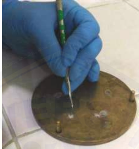
Gambar 3.11 Cetakan Berbentuk Silinder Diisi dengan Glass Ionomer dengan Tambahan 0,04 wt% Bioactive Glass Nano Silica dari Abu Ampas Tebu (Dokumentasi Pribadi).
