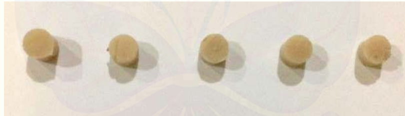
Gambar 3.12 Pandangan Atas Sampel Glass Ionomer dengan Tambahan 0,04 wt% Bioactive Glass Nano Silica dari Abu Ampas Tebu Setelah Dikeluarkan dari Cetakan (Dokumen Pribadi).
