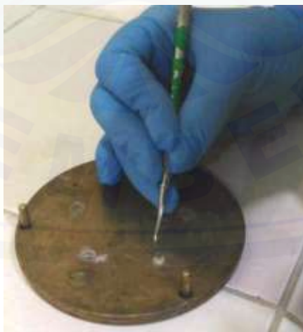
Gambar 3.8 Cetakan Berbentuk Silinder Diisi dengan Glass Ionomer (Dokumentasi Pribadi).
