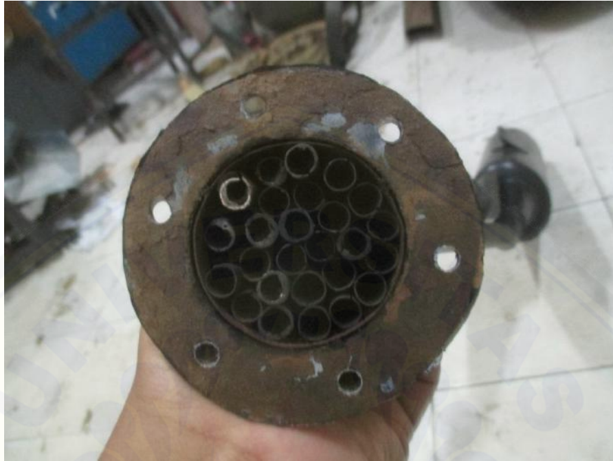
Gambar D.3 Desain catalytic converter dengan pipa berlubang
