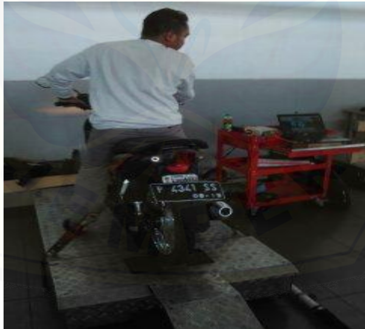
Gambar D.4 Ruang pengujian (Chassis dynamometer, konsol pengonversi, dan seperangkat komputer)
