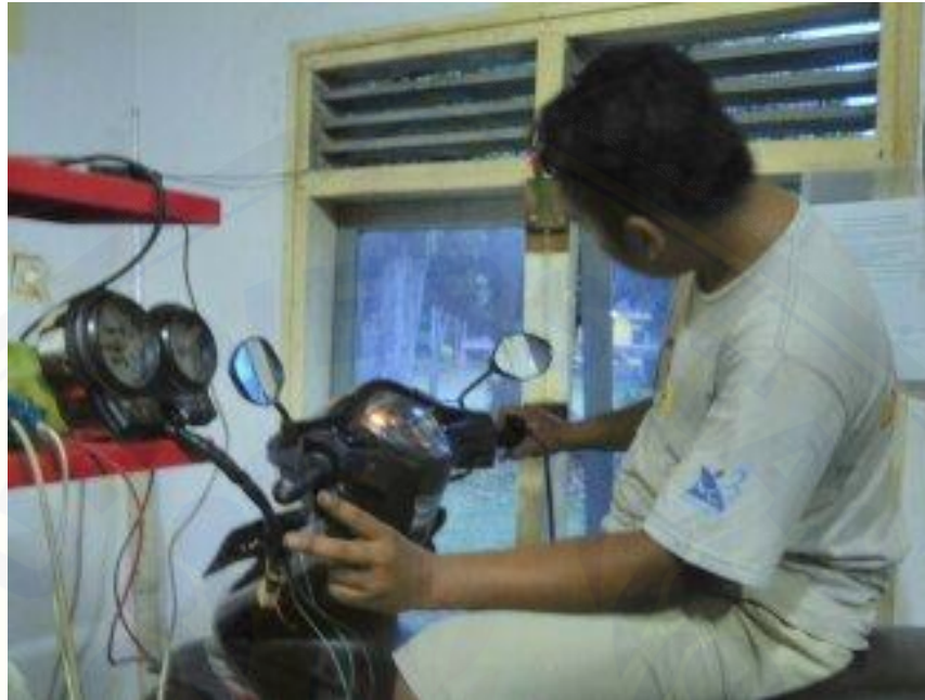
Gambar D.9 Ruang pengujian Konsumsi Bahan bakar (Tachometer, buret)
