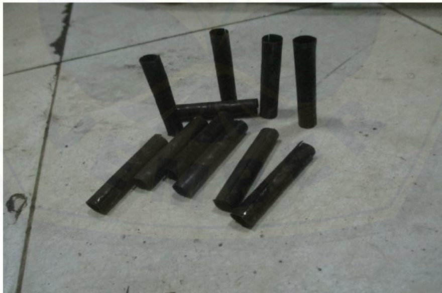
Gambar D.2 Pipa katalis dengan bahan baja karbon A 36
