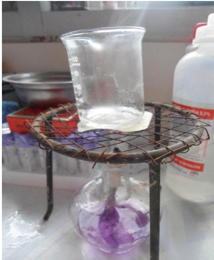
Gambar G.5 Pembuatan Asetosal
