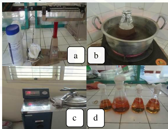
Gambar 3.1 Proses Pembuatan Media SDAY.(a) menimbang media SDA dan yeast ekstrak, (b) menghomogenkan media SDAY di atas kompor gas, (c) sterilisasi media SDAY menggunakan autoklaf, (d) media SDAY telah steril
