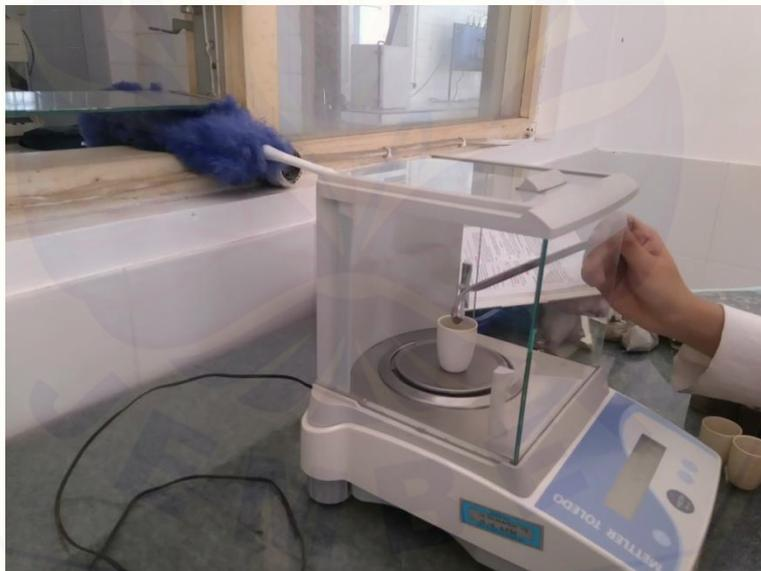
Gambar 4. Penimbangan Sempel Tanah Basah
