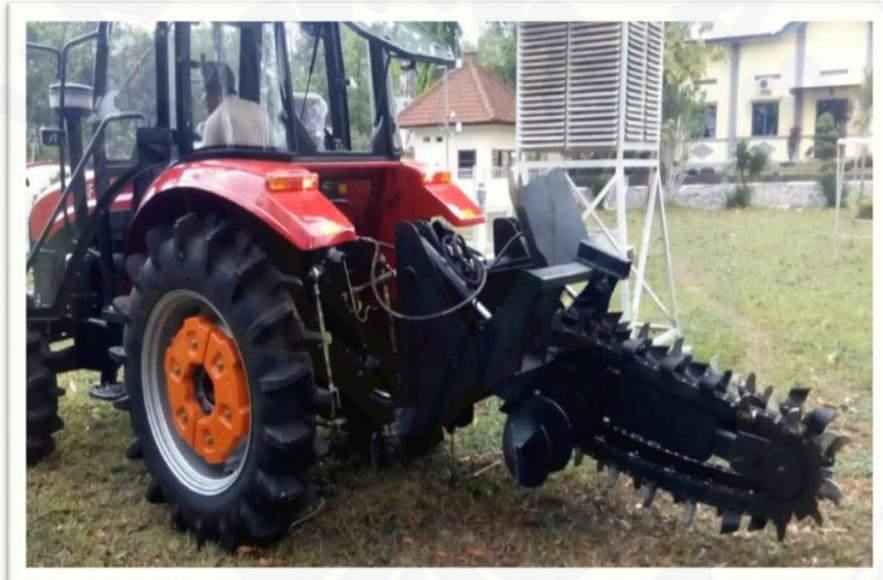
Gambar 2.1 Alat *Trencher* (sumber:dokumentasi PTPN X Jember)
