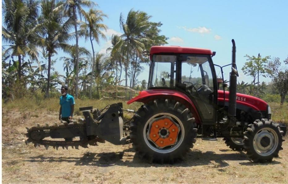
Gambar 1. *Trencher* dan Traktor Roda Empat
