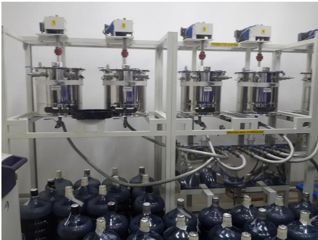
Gambar 1.4 Fermenter kapasitas 30 L (milik pupuk kujang)
