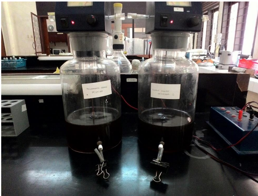
Gambar 1.3 Pembiakan massal agen hayati tunggal dalam fermentor kapasitas 2 L
